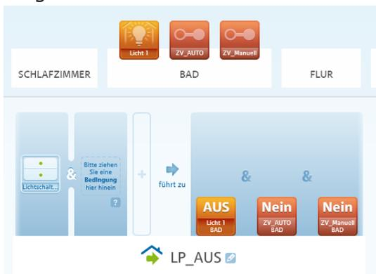
LogikProfil LP\_AUTO\_OFF, erlaubt die automatische Abschaltung des Lichts, wenn keine
