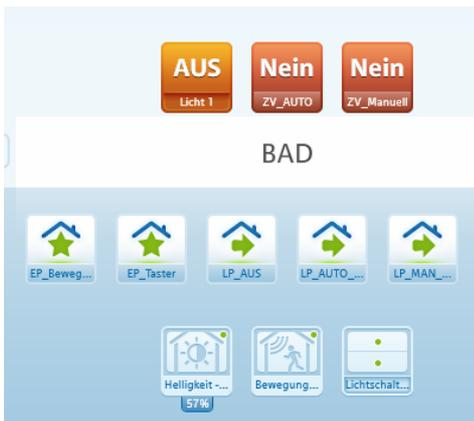
LogikProfil LP\_AUS, gesteuert durch Tasterwippe unten, werden Licht 1 und beide ZV's ausgeschaltet:
